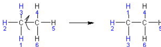
Abbildung 3.10: Freie Drehbarkeit um die C-C-Bindung
